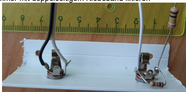
Kunststoffwinkel mit Morsetastenanschluss links und Soundkartenanschluss rechts mit 3,5mm Klinkenbuchsen mono
