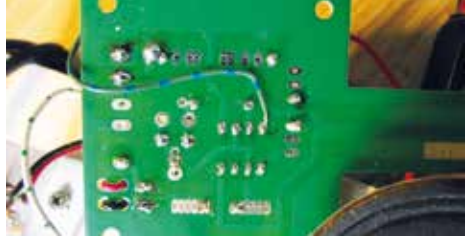
Bild 2: Anschluss des Tastenkontaktes für die Tastenbuchse auf der Leitbahnseite der Morsetaste (Ausführung ab 2015)
