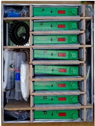
Foxoring-Koffer 1: von links oben nach unten ein Stempel, das Kontrollgerät, die Sender, ein Dreieckstuch zum Blindpeilen und der zweite Stempel
